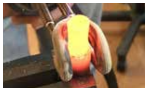
Soldadura por inducción de tubos de cobre con soldador de plata.
