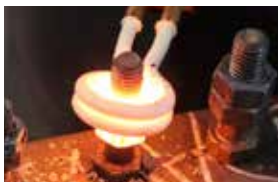
Calentamiento por inducción de piezas metálicas mediante una bobina circular.
