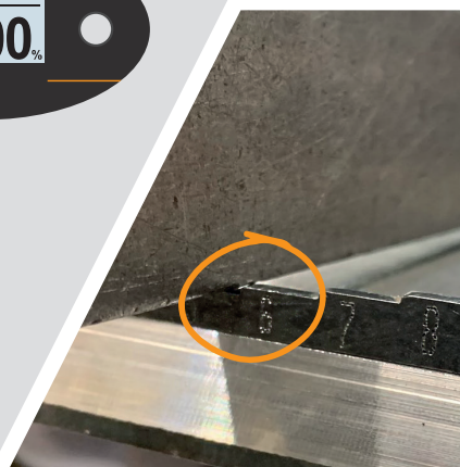
Enderezamiento del material en 5 mm
